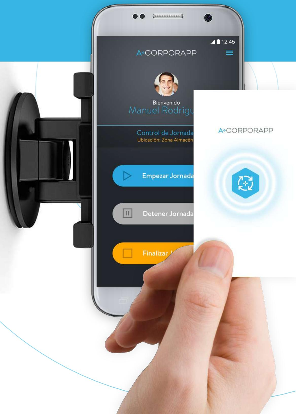
Consiste en disponer de una serie de terminales (**smartphones con NFC**) situados en las zonas de entrada/salida de la empresa. En dichos terminales estará instalada la aplicación que espera que los empleados registren su entrada/salida. Para ello los empleados deben disponer de una tarjeta (**o elemento NFC**) proporcionado por la empresa y que lo identificará.
